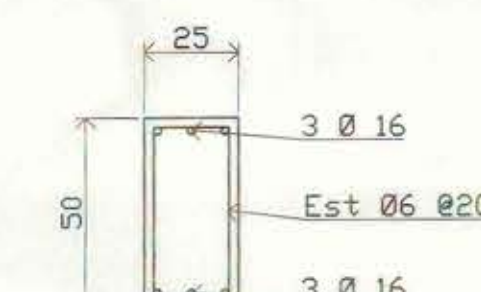
VIGA V-202 ESCALA 1 : 20
