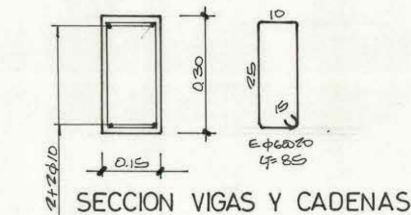
SECCION VIGAS Y CADENAS 15/30
