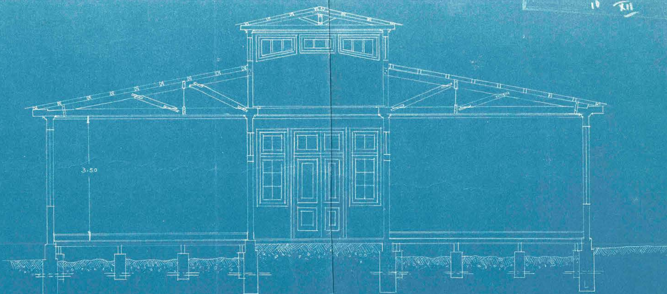
SECCION TRASVERSAL DEL PABELLON DE LAS SALAS DE CLASES
