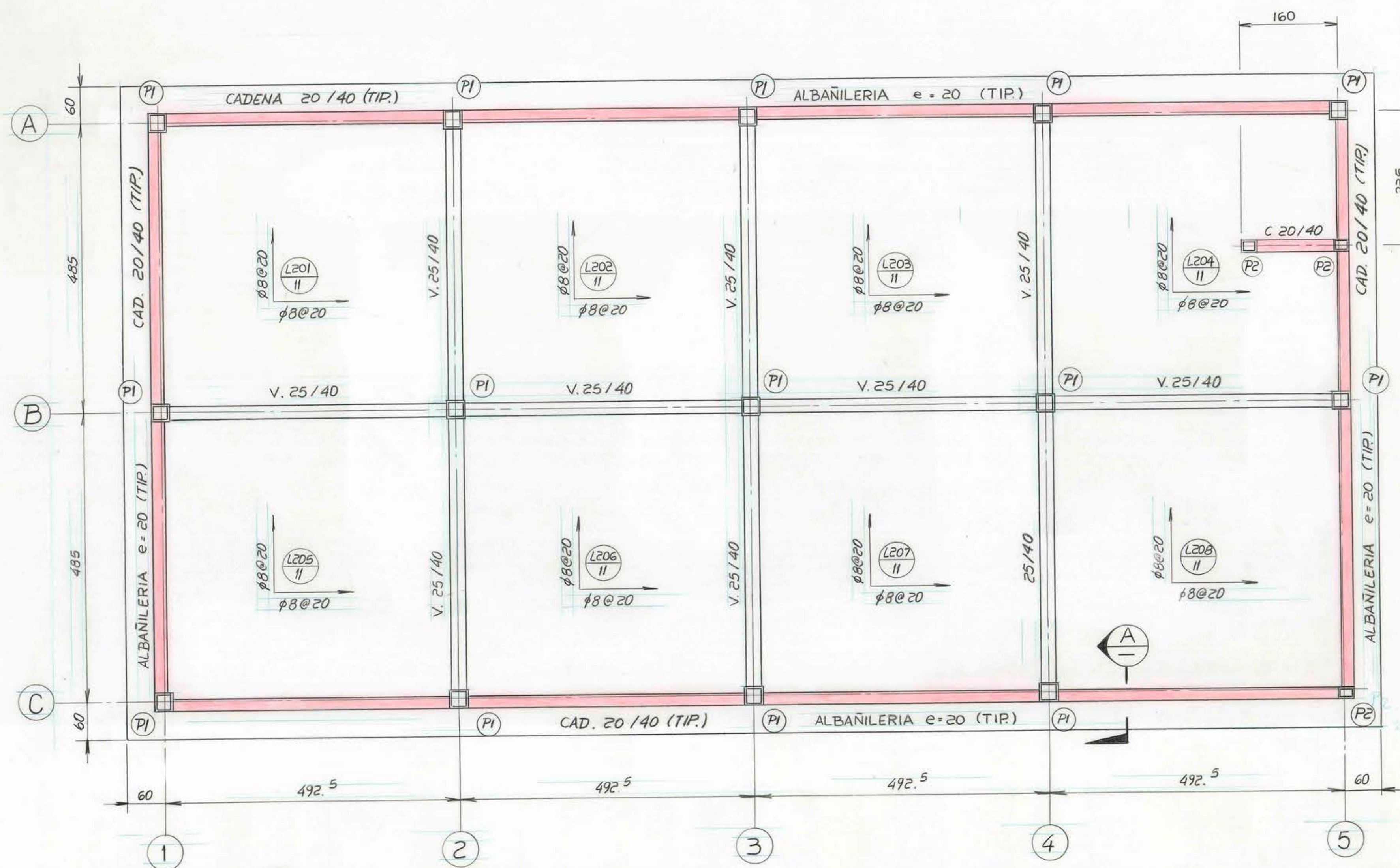
PLANTA DE ESTRUCTURAS PISO 2°
