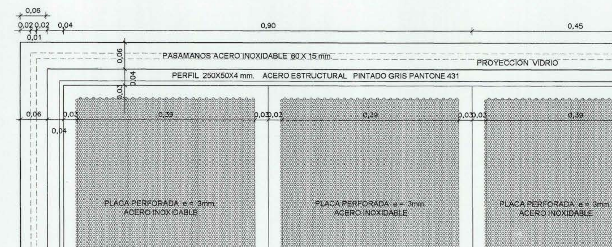
DETALLE MÓDULO ACERO INOX. ESCALA : 1/5
